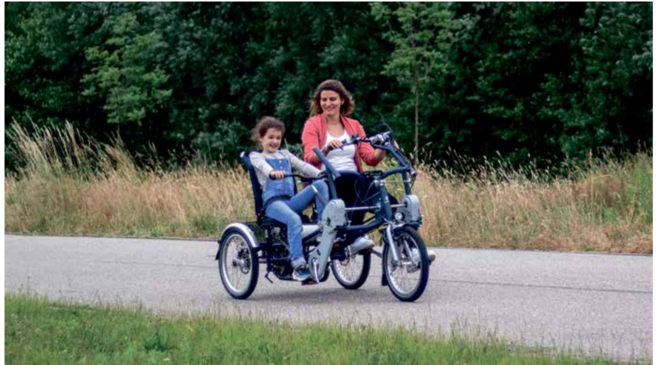
Un autre « tricycle » intéressant, le *Fun2Go*. Ce vélo électrique à trois roues biplace permet à deux personnes de pédaler, indépendamment l'un de l'autre. Pouvant tourner sur son propre axe, ce triporteur revêt ainsi une maniabilité excellente. Le confort et la sécurité sont de mise, avec des sièges ajustables, amovibles, ainsi que des ceintures de sécurité et des accoudoirs amovibles.
