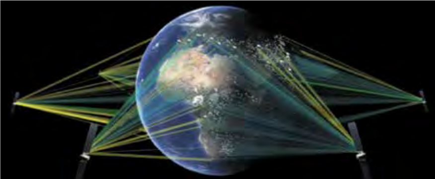
Die neueste Generation der SES-Satelliten in mittlerer Umlaufbahn strahlt Tausende von gebündelten Signalen aus und eignet sich besonders für mobile Empfangssysteme.
